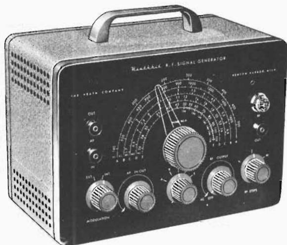
L'oscillatore modulato, (detto anche «generatore di segnali») mod. «SG-8», qui descritto, è uno strumento versatile, di facile impiego, e di funzionamento sicuro. La sua realizzazione non comporta notevoli difficoltà, in quanto il circuito si basa sull'impiego di stadi oscillatori, analoghi a quelli descritti nella precedente lezione.
