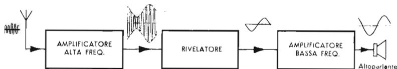
Fig. 6 - Un ulteriore perfezionamento consiste nella amplificazione a Bassa Frequenza; dopo la rivelazione, le oscillazioni a frequenza fonica, amplificate, possono allora azionare un altoparlante in luogo della semplice cuffia.
