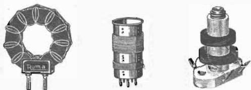
Fig. 16 — Le bobine di induttanza possono assumere forme diverse. A sinistra una bobina cosiddetta a « nido d'ape », oggi non più usata; in centro una bobina intercambiabile; a destra bobine con nucleo regolabile.
