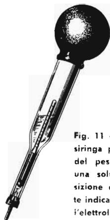
Fig. 11 - Densimetro a siringa per il controllo del peso specifico di una soluzione. La posizione del galleggiante indica la densità dell'elettrolita.
