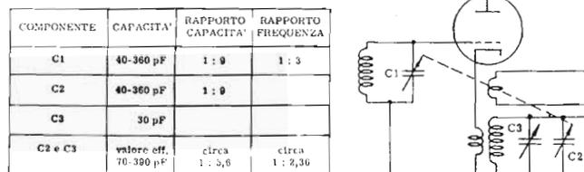
Fig. 8 - Impiego del «trimmer» per la regolazione della variazione di capacità mediante l'aggiunta di un valore in parallelo. Come si nota nella tabella a lato, sebbene C<sub>3</sub> abbia un valore ridotto, la sua presenza consente una notevole diversità dei rapporti sia di capacità che di frequenza.
