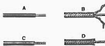
Fig. 21 — Fili per collegamenti. Possono essere a conduttore unico (A) e a più conduttori, sottili, intrecciati (B); a volte l'isolante è ricoperto da una fascia metallica (fili schermati) come in C e D.
