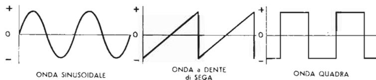
Fig. 2 — Le correnti alternate non sempre seguono l'andamento sinusoidale. Si incontrano spesso, in elettronica, onde a forma di dente di sega o a forma quadra, che vengono rappresentate così come dalla figura. L'aumento e la diminuzione dell'ampiezza si effettuano evidentemente in tempi diversi tra loro.
